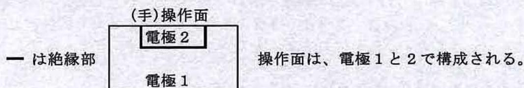
手が操作面の電極 1, 2 に接触しない時はスイッチOFF
