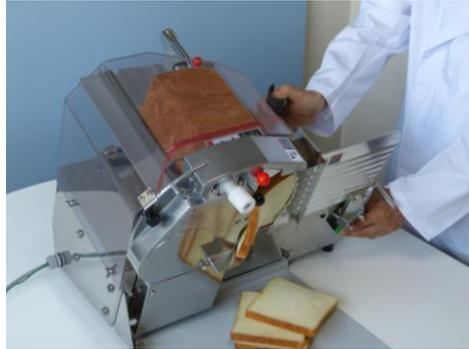
2つのボタンを両手で操作している間のみ、刃が回転する。(片手をボタンから離れたときは刃が急停止。)
