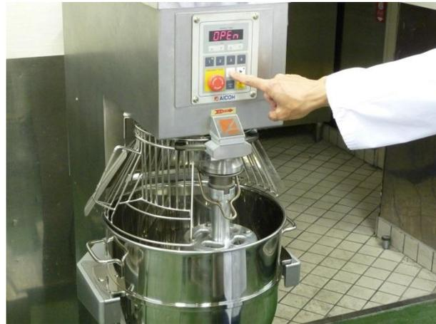
ホールド・トゥ・ラン制御装置(可動式覆いを開いた状態のときでも、ボタンを押している間に限り、低速で回転する。)を有するミキサー
