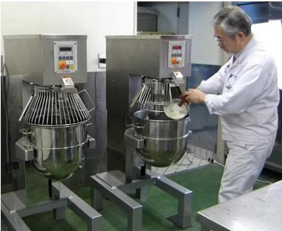
インターロック機構(可動式覆いを閉じないと回転部が動かない機能)を有するミキサー
